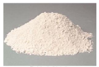
Fig. 1: Sample of Met kaolin.
