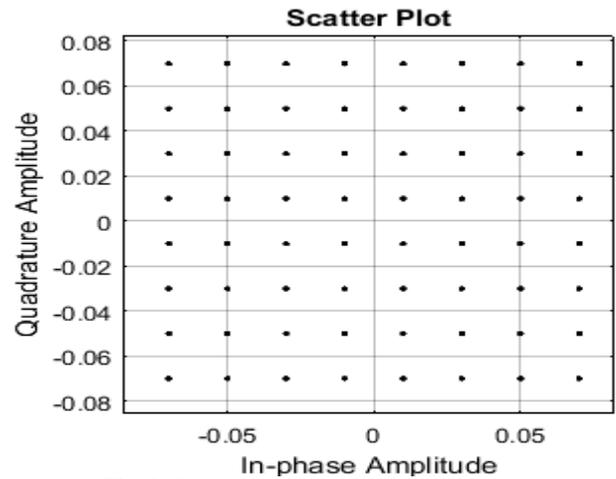
Fig. 6: Constellation Plot: AGC Input 64-QAM.
