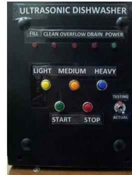
Fig. 8: The photo of the actual control panel.
