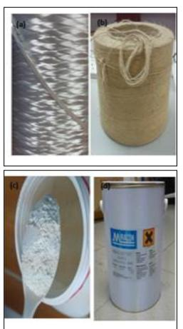
Fig. 1: Materials used ; (a) glass roving; (b) kenaf yarn; (c) montmorillonite clay; (d) epoxy
