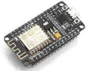
Fig. 3: ESP8266-12E NodeMCU v-1.0
