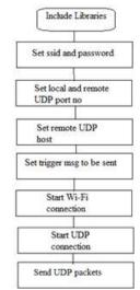
Fig. 4: Sender NodeMCU flowchart
