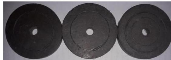
**Fig. 12:** Specimens composition 80 wt. % filler and 20 wt. % matrix.
