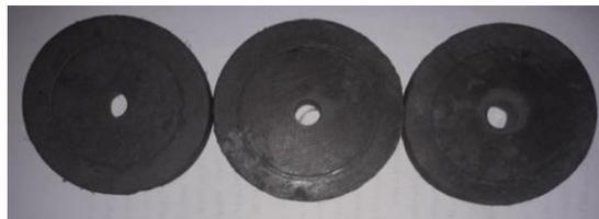
**Fig. 10:** Specimens composition 60 wt.% filler and 40 wt. % matrix.
