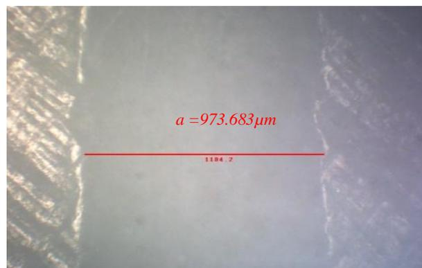
**Fig. 13:** Wear track width composition 50 wt. % filler and 50 wt. % matrix (zoom 50 X).
