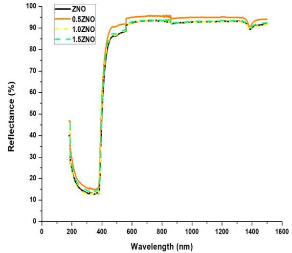
**Fig. 4:** The reflectance spectrum of (a) ZNO, (b) 0.5ZNO, (c) 1.0ZNO and (d) 1.5ZNO
