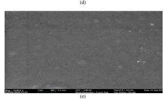
Fig. 10: FESEM micrograph of (a) EMG30 (b) EMG30-35 wt.%  $LiCF_3SO_3$  (c) EMG30-40 wt.%  $LiCF_3SO_3$  (d) EMG30-45 wt.%  $LiCF_3SO_3$  (e) EMG30-LiCF\_3SO\_3-EC.
