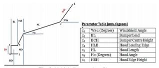
Fig. 3: Vehicle Front-end profile parameters
