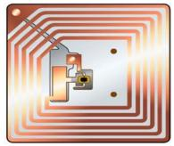
Fig. 3: Basic RFID Tag.
